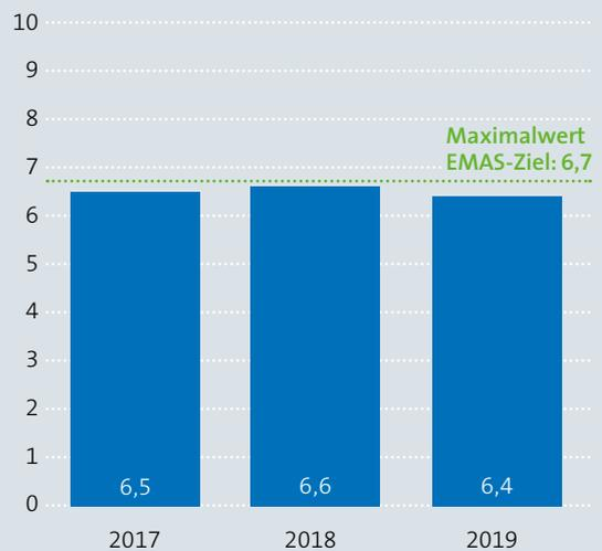
Witterung in 2019 wurde das Ziel mit  $6,4 \text{Wh}/(\text{m}^3 \cdot \text{m})$  klar unterschritten. Positiv wirkte sich dabei aus, dass die Sanierung des Pumpwerks Universität abgeschlossen wurde und das Pumpwerk mit neuen, effizienten Pumpen wieder in Betrieb gehen konnte.
